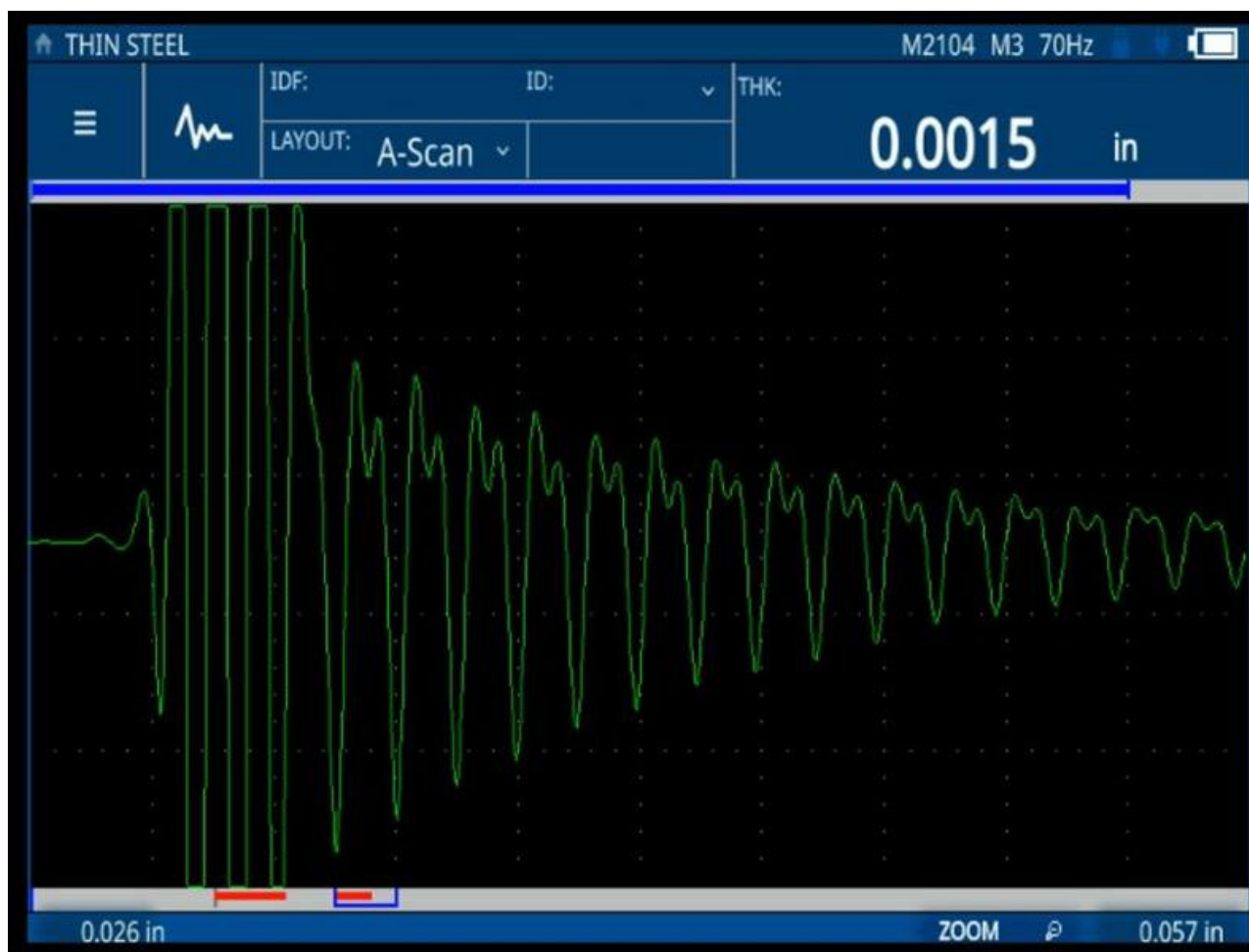
El medidor 72DL PLUS ejecuta una medición sobre una lámina de acero delgada (0,0381 mm o 0,0015 pulg.) con la sonda M2104 (125 MHz)
